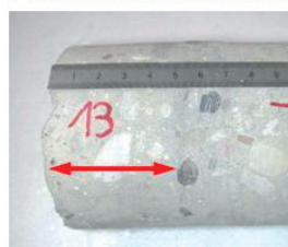
Rys. 6. Wyniki pomiarów lokalizacji zbrojenia
