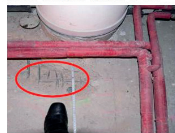
Rys. 6. Wyniki pomiarów lokalizacji zbrojenia
