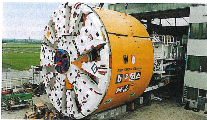
Rys. 7. Tarcza zawieszinowa o średnicy 14,20 m z Hamburga [8]
