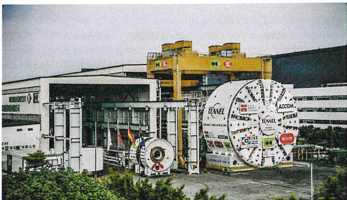
Rys. 3. Tarcza zawieszinowa o średnicy 17,63 m i tarcza AVN; odbiór maszyn u producenta [5]
