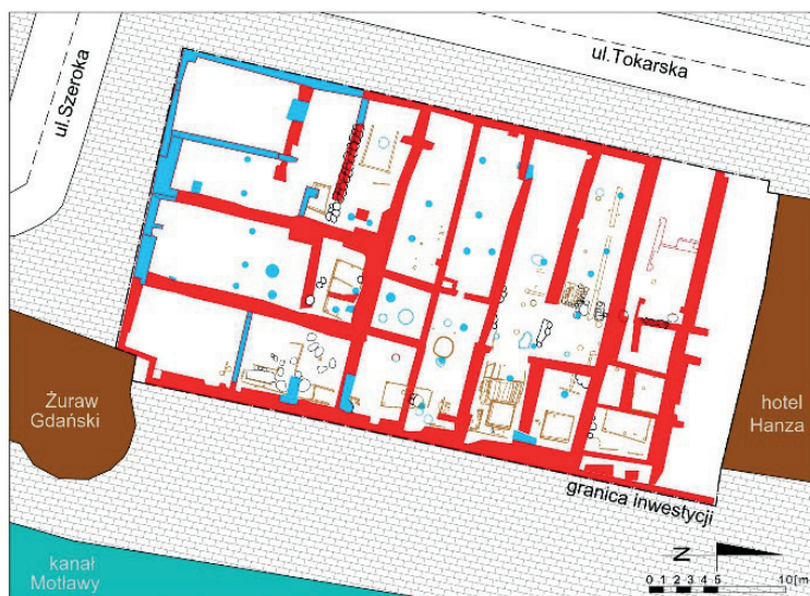
Rys. 2. Schemat usytuowania zainwentaryzowanych podczas badań archeologicznych przeszkód w gruncie, w tym: starych fundamentów, murków ceglanych, pali Wolfsholza , otoczaków, elementów drewnianych
