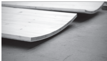
Rys. 2. Panel dwuwarstwowy po odkształceniu (ICD/ITKE University of Stuttgart and EMPA/ETH Zürich) [1]
